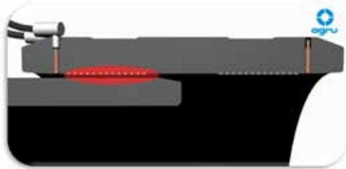
Abbildung C.17: Prinzip des bifilaren Heizwendelschweißens
